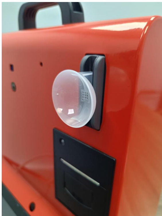
Рисунок 5-6 – Варианты подключения воронки или мундштука в анализатор паров этанола в выдыхаемом воздухе Комплекса
