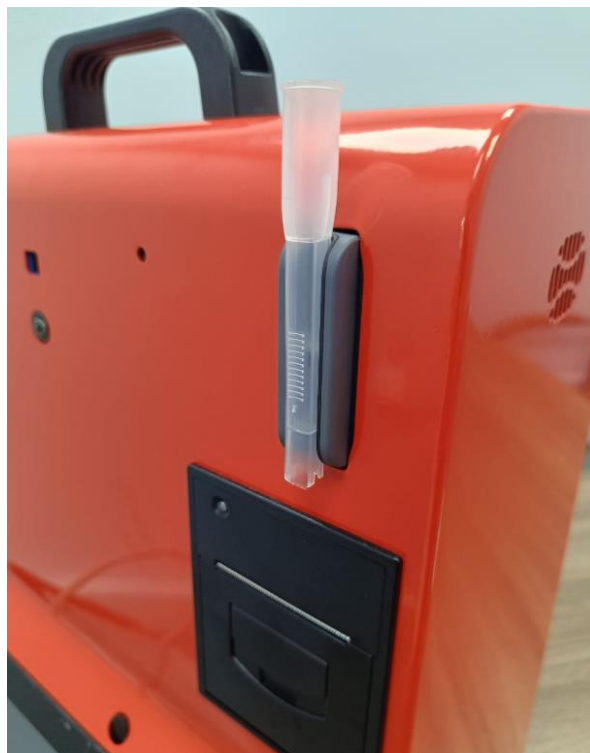
Рисунок 5-6 – Варианты подключения воронки или мундштука в анализатор паров этанола в выдыхаемом воздухе Комплекса
