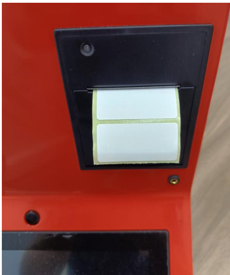
Рисунок 7 – Установка рулона наклеек в термопринтере
